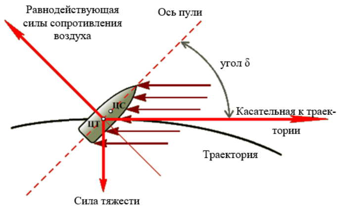
Рис. 1.9. Действие силы сопротивления воздуха на полет пули: ЦТ — центр тяжести; ЦС — центр сопротивления воздуха
