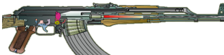
Рис. 2.6. Работа частей и механизмов АК-74
