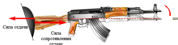
Рис. 1.6. Подбрасывание дульной части ствола оружия вверх при выстреле в результате действия отдачи
